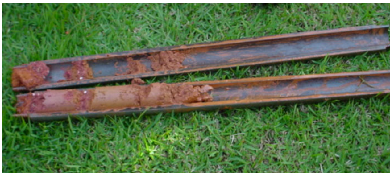
Figura 5 – Amostrador Padrão
