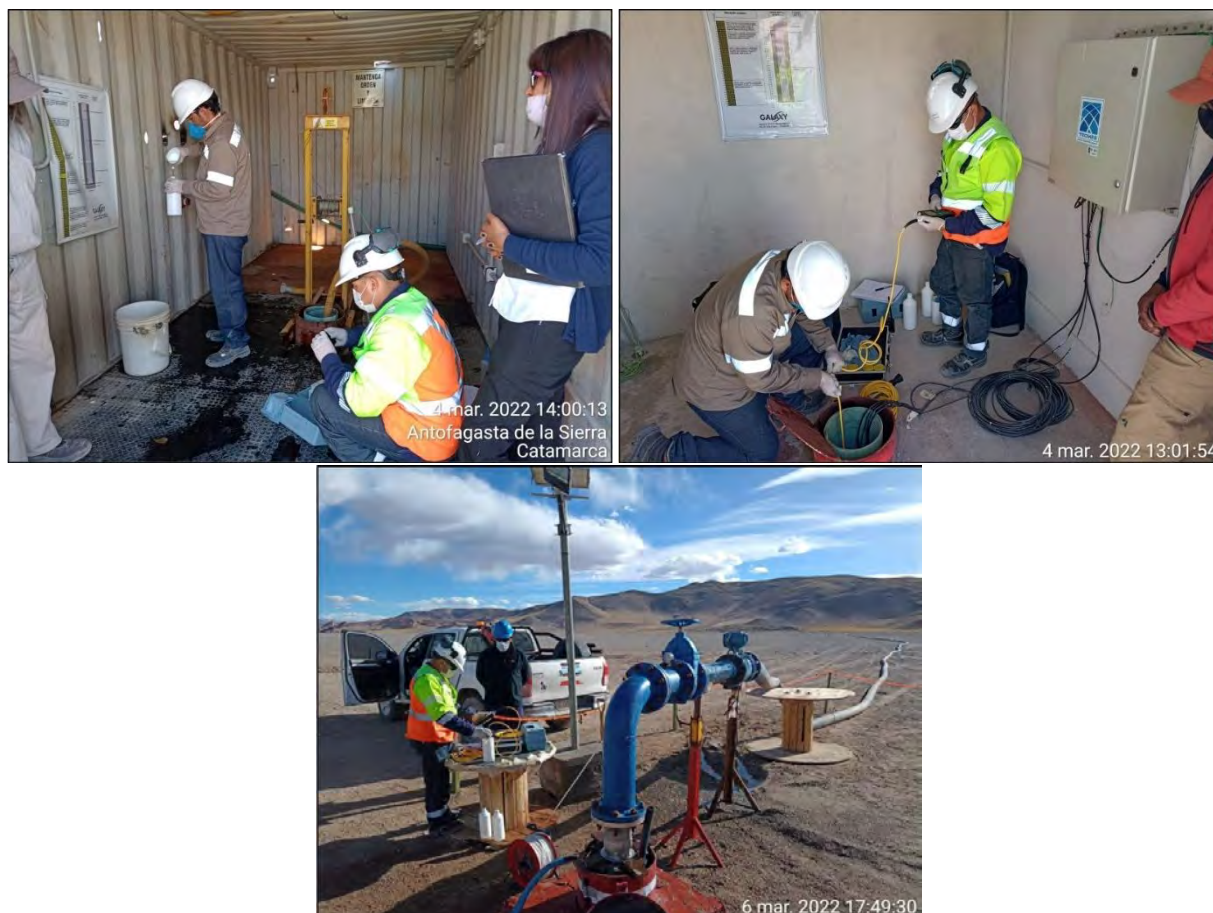
Foto II-13. Monitoreo, medición de parámetros y recolección de muestras en sitio SV-M10 (arriba a la izq.), SV-M11 (arriba a la der.) y SV-M12 (abajo), correspondientes a los pozos de agua SVWF12_19, SVWF12_20 y SVWF21_21, respectivamente.
