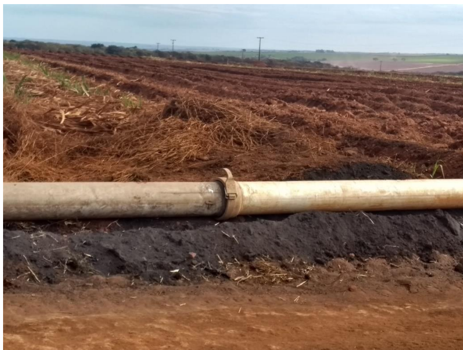
Figura 31. Detalhe do engate rápido nas tubulações utilizadas no sistema de fertirrigação autopropelido.
