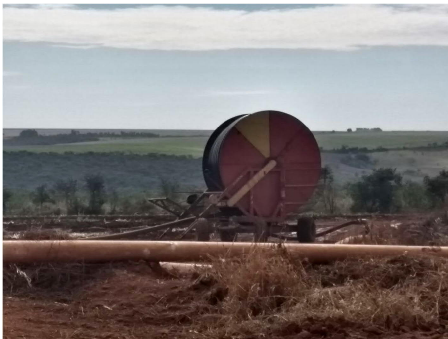
Figura 10 – Detalhe do carretel utilizado no sistema de fertirrigação autopropelido.
