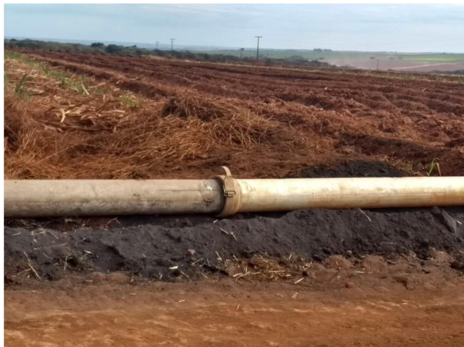
Figura 8 – Detalhe do engate rápido nas tubulações utilizadas no sistema de fertirrigação autopropelido.
