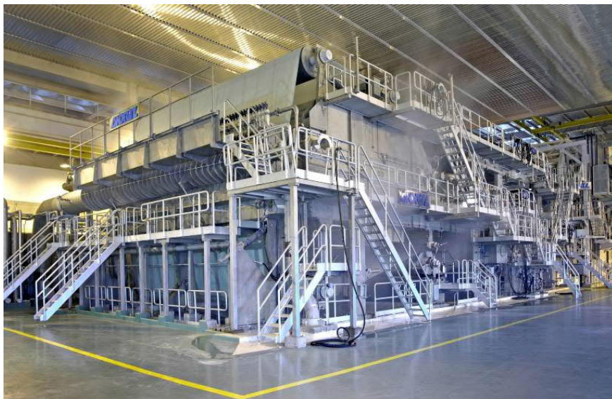
Figura 6 – Máquina de secagem de celulose. Fonte: Pöyry, 2018.
