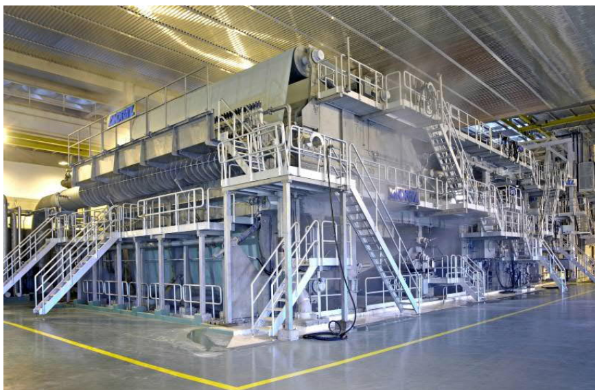
Figura 9 – Máquina de secagem de celulose. Fonte: Pöyry, 2018.
