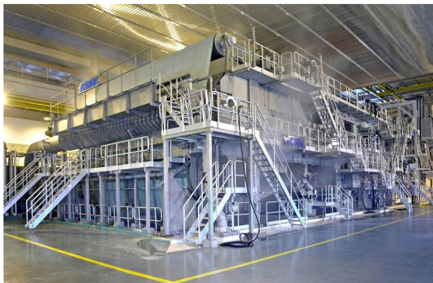
Figura 6 – Máquina de secagem de celulose. Fonte: Pöyry, 2018.
