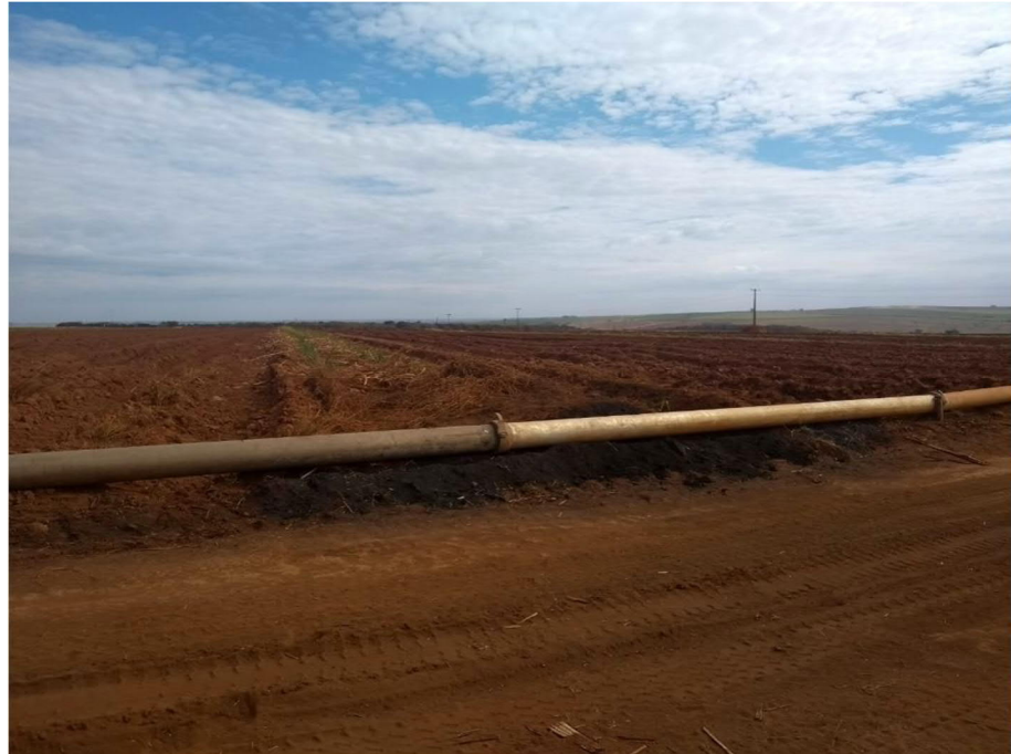
Figura 7 – Exemplo de distribuição em campo da adutora por parcela usado no sistema de fertirrigação autopropelido.
