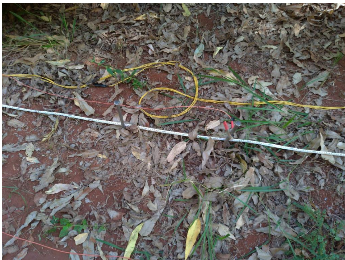
Figura 21 Desenvolvimento da técnica da Sondagem Elétrica Vertical em campo.
