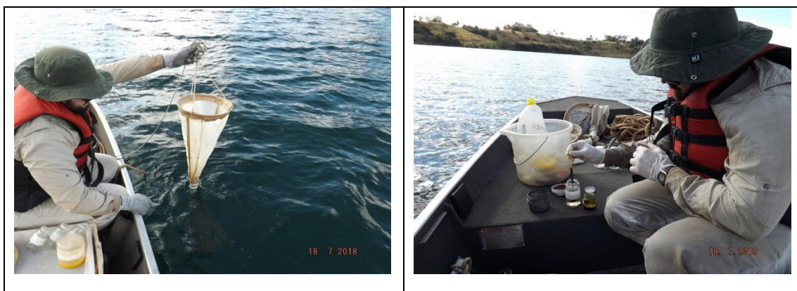
Figura 3 – Metodologia de coleta das comunidades planctônicas (coleta com rede cônico-cilíndrica a esquerda e fixação do fitoplâncton com lugol a direita)
