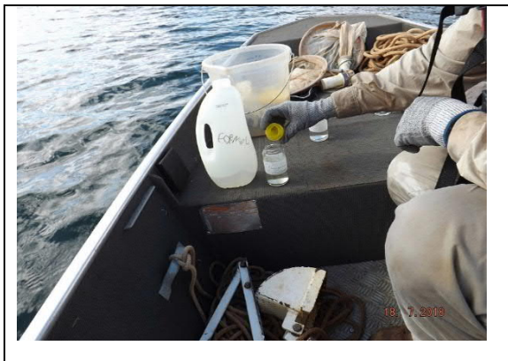
Figura 4 – Metodologia de coleta das comunidades planctônicas. Fixação do zooplâncton com formol
