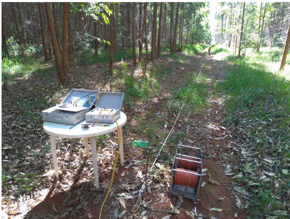
Figura 22. Desenvolvimento da técnica da Sondagem Elétrica Vertical em campo.
