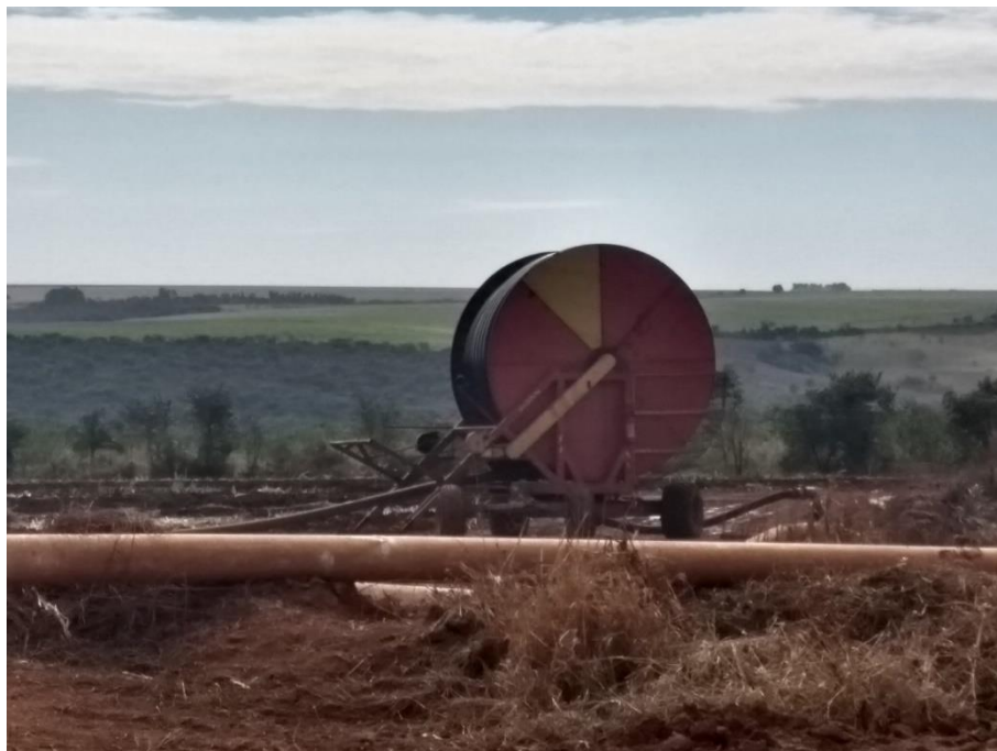
Figura 33. Detalhe do carretel utilizado no sistema de fertirrigação autopropelido.
