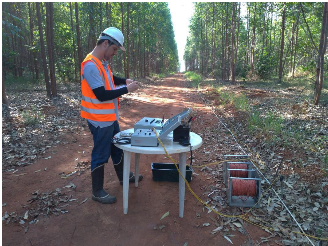
Figura 20. Desenvolvimento da técnica da Sondagem Elétrica Vertical em campo.
