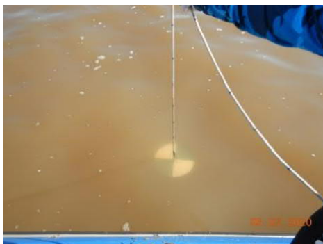
Figura 415 – Medición de la transparencia con el disco Secchi.
