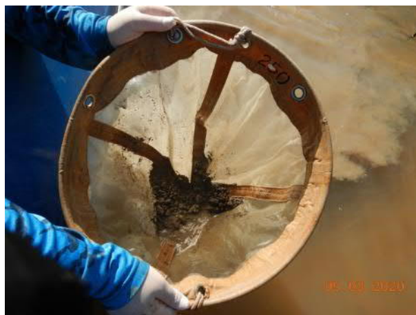
Figura 424 – El lavado de los sedimentos en un tamiz de 250 µm de apertura.
