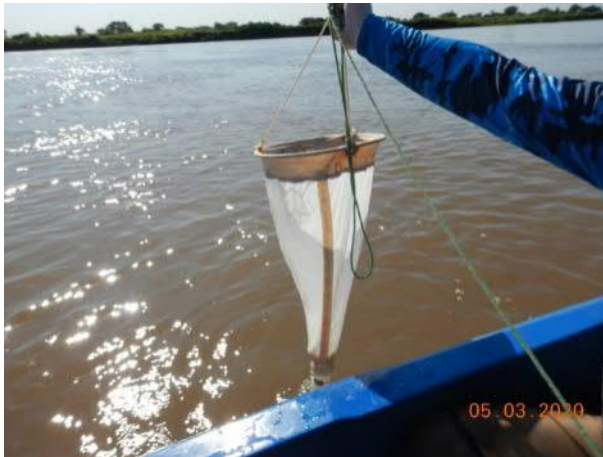
Figura 417 – La red de 20 \mu m utilizada para el muestreo cualitativo.
