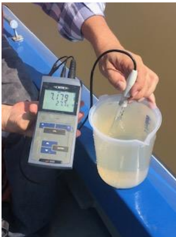
Figura 75 – Medición del pH y temperatura in situ . Fuente: INYMA (2019)
