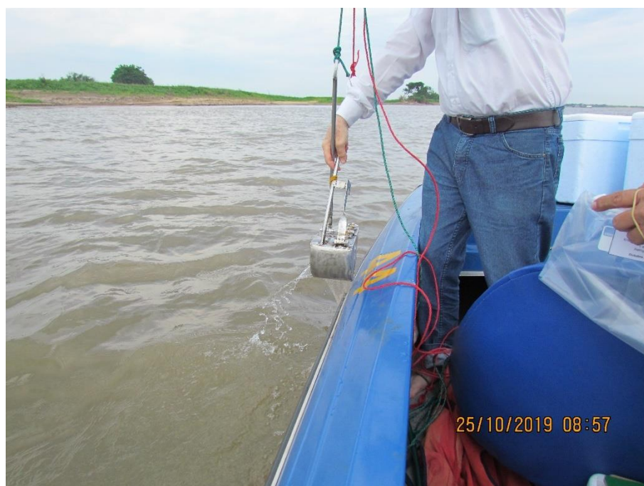
Figura 76 – Draga para muestreo de los sedimentos. Fuente: Pöyry Tecnología (2020)
