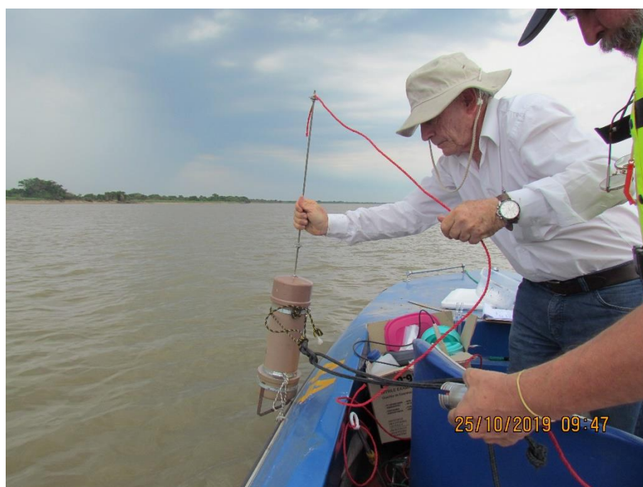
Figura 74 – Equipo para muestreo de aguas superficiales en profundidad. Fuente: Pöyry Tecnología (2020)
