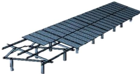
**Figura 1.7.** Ejemplo de una estructura fija (2V)
