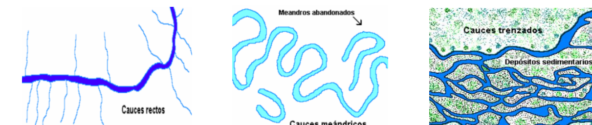
Figura 2-47 Esquema de Patrones de drenaje en cuencas
