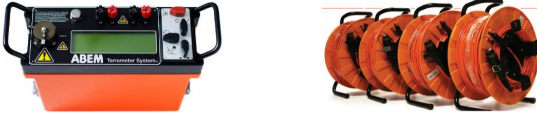
Figura 2-69 Instrumentos utilizados para la cartelización geofísica TERRAMETER
