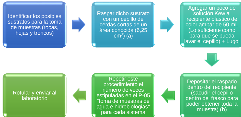
Figura 2-97 Diagrama de flujo esquematizando la toma de muestras de la comunidad perifítica
