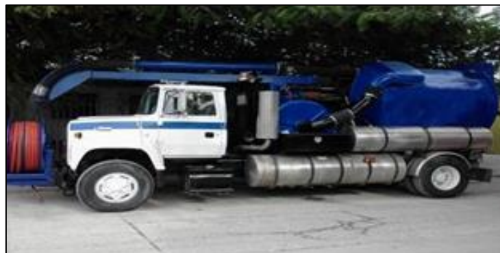
Figura 7-2. Equipo Vactor de 10 m 3 para transporte de aguas residuales proveniente de los baños en etapa de operación.
