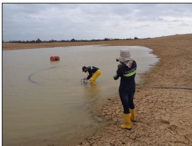
Imagen 2-7. Medición de parámetros en campo Jagüey de Sukuluwou (temperatura, pH, oxígeno disuelto etc.) (mayo de 2018)
