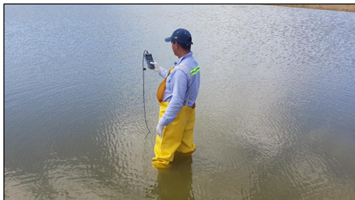
Imagen 2-10. Medición de parámetros en campo (temperatura, pH, oxígeno disuelto etc.) Jagüey Soshinchon (enero de 2019)
