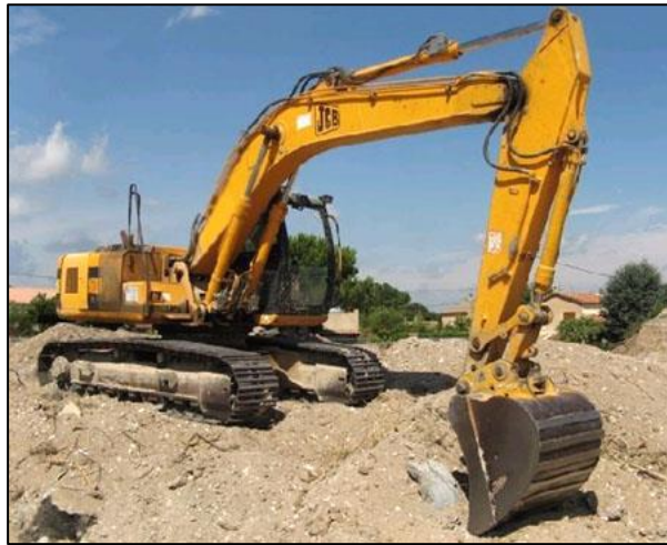
Figura 3-22. Retroexcavadora sobre oruga
