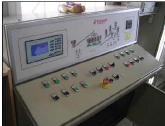
Figura 3-55. Accionamiento de carga
