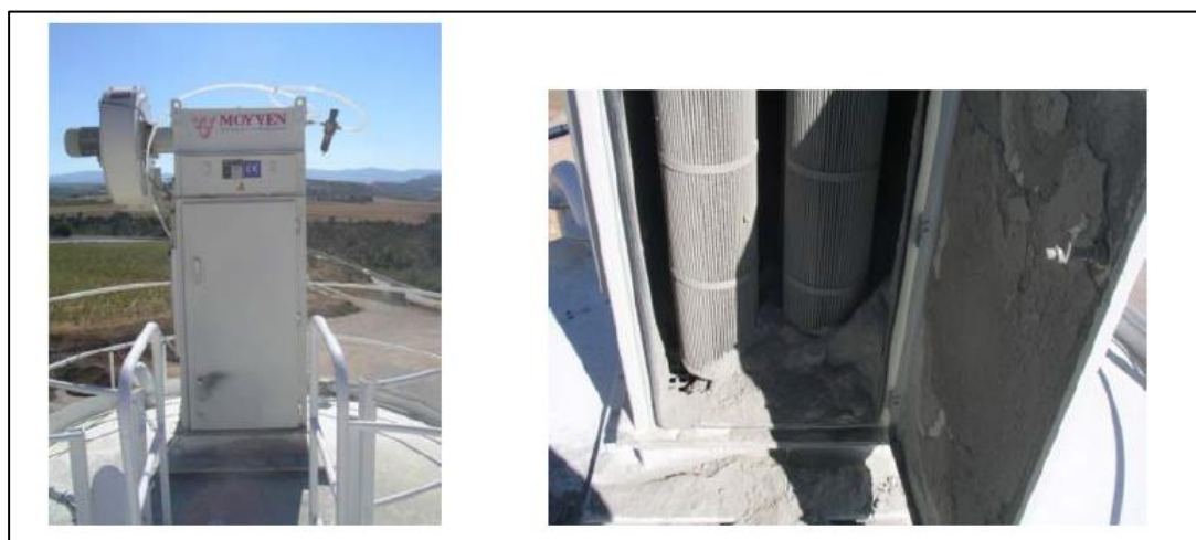
Figura 3-52. Filtro de cemento y detalle del interior
