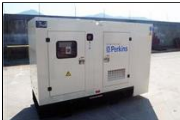
Figura 3-56. Grupo electrógeno 250 Kva
