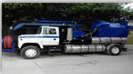
Figura 7-2. Equipo Vector de 10 m 3 para transporte de aguas residuales proveniente de los baños en etapa de operación.
