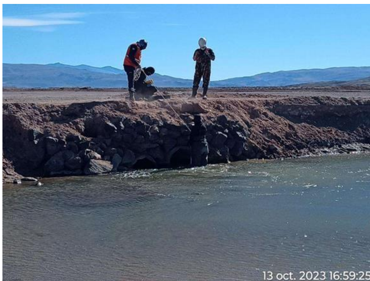
Fotografía 4.22. Aforo de caudal con molinete en Punto de punto A1. Fotografía 4.23. aforo A2.
